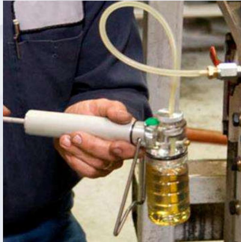
Contaminación, viscosidad, existencia de partículas en el aceite por desgaste mecánico, corrosión, etc.
