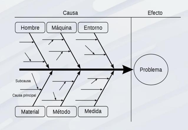
Esta herramienta tan versátil nos permite evaluar las posibles causas de la falla en distintas dimensiones, aportando un análisis multidimensional que, al realizarse después de describir el principio de operación y funcionamiento, nos permite identificar con mayor certeza la o las causas más probables.
